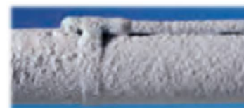
La sonde SPTPE résiste au givre
