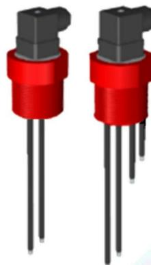
Le détecteur de liquide à électrode conductrice est conçu pour détecter la présence de liquide conducteur pour les puits et réservoirs. Il convient pour les applications de fluide propre ou peu chargé. Ce dispositif s'associe avec un relais de niveau pour un contrôle de niveau minimum ou/et maximum
