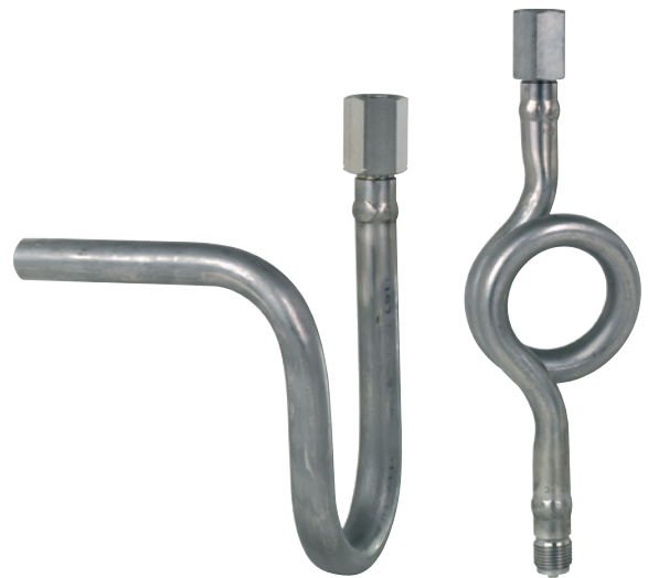
Siphons pour manomètre DIN 16 282, acier inox A gauche : Forme B, en U A droite : Forme D, en cor de chasse
