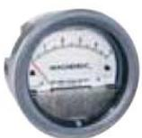
Modèles MP et HP Installation identique à l'exception du perçage du panneau pour l'encastrement, 122 mm au lieu de 115 mm. La pression d'épreuve pour la version MP est de 240 kPa et pour la version HP de 550 kPa.
