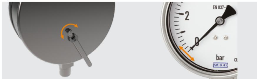
En cas d'un écart de l'aiguille par rapport au point zéro (en état hors pression), le réglage du point zéro est possible en tournant l'écrou hexagonal placé à l'arrière de l'instrument. Pour régler l'écrou hexagonal, une clé plate de 7 mm de large est nécessaire.
