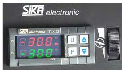
Figure n°11 : Façade du régulateur avec molette de réglage
