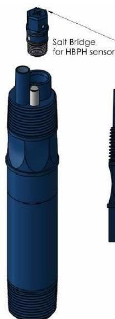
1. En maintenant le capteur en position verticale, dévisser le pont salin à l'aide d'un tournevis cruciforme n°3 ou d'une clé 1/2". Ne pas utiliser pas de tournevis plus petit que n°3 pour éviter de glisser et d'endommager les surfaces adjacentes
