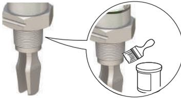
2. Visser le détecteur de niveau sur le raccordement au procédé.
