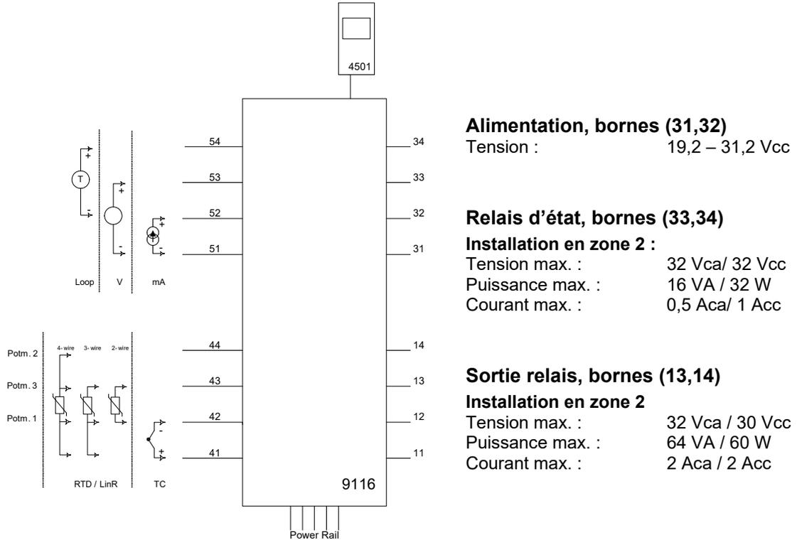
Pour l'installation dans la zone 2, le module doit être installé dans une enceinte externe ayant une protection de type Ex n ou Ex e, assurant une protection d'étanchéité au moins d'IP54. Les raccords de câble et les bouchons doivent remplir les mêmes exigences.
