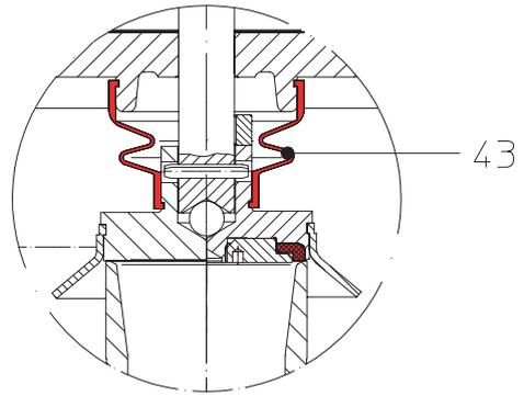
Clapet avec insert en matériau souple WEDI / Soufflet d'étanchéité EPDM
