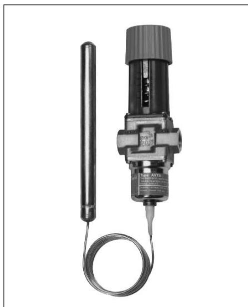
Les vannes thermostatiques AVTA jouent un rôle important dans la régulation de la température de nombreuses machines et installations sur lesquelles un refroidissement est nécessaire. Les vannes de refroidissement AVTA s'ouvrent toujours pour laisser entrer le débit lorsque la température de la sonde augmente.
