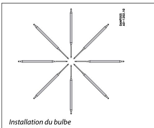
La charge est composée de charbon actif et de CO<sub>2</sub>, lequel est absorbé lorsque la température de la sonde baisse, produisant un changement de pression dans l'élément.
