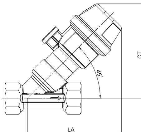
**Dimensions de l'actionneur / Cotes d'encombrement - Vanne avec corps de passage en équerre [mm]**
