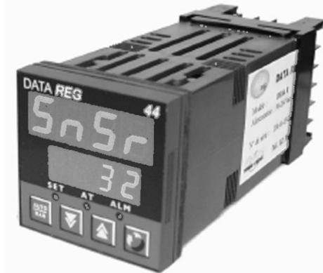
Le **DATA REG 441** est un régulateur numérique 48 x 48 (1/16 DIN) pouvant être entièrement modulé au besoin de l'utilisateur par l'adjonction de cartes de sorties sur les 4 connecteurs disponibles. Il pourra ainsi s'adapter aux process demandant une sortie discontinue (relais / statique SSR / triac) ou continue (courant / tension). Il permet de réaliser des boucles de régulation performantes et adaptées à toutes les applications : pression, température, débit, ...
