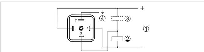
Schéma de raccordement connecteur ISO 4400 - Sortie transistor, trois fils
