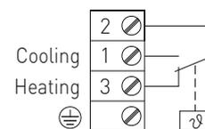
**THERMASREG® TR 040 / TR 060** Thermostat ambiant à un étage
